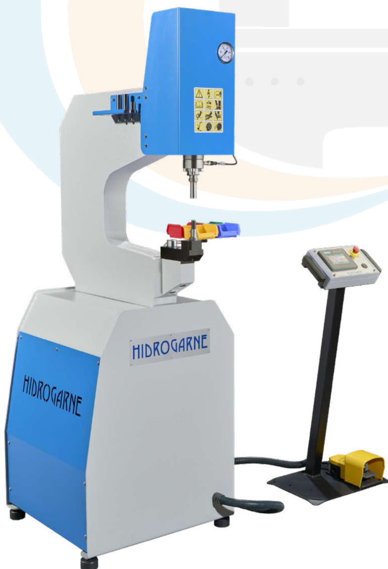
Модель 60 – стандартна цифрова версія, зусилля 6 тонн
