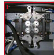
1. система подавання зварювального дроту
