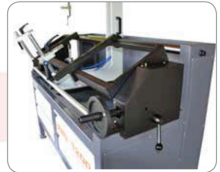
Регулювання обертання столу на 20° вперед
